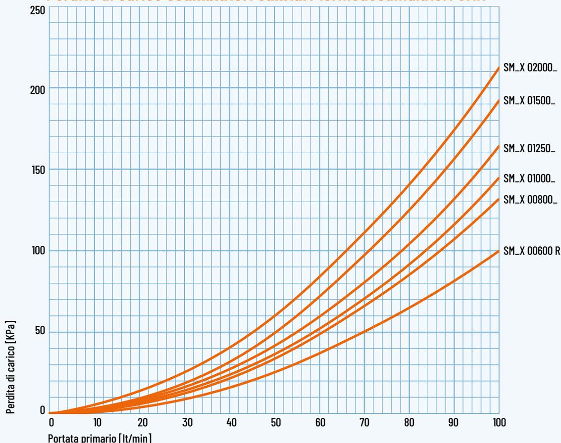
**Perdite di carico scambiatori inf. primario (rame alettato) termoaccumulatore combinato SMX**
