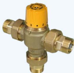
Miscelatore termostatico antiscottatura per piccole e medie utenze con attacchi filettati maschio a bocchettone. Valvole di non ritorno e filtri, inseriti nei raccordi, agli ingressi dell'acqua calda e fredda. Corpo e raccordi in lega di ottone antidezincificazione.
