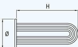
**Fascio tubiero in acciaio inox AISI 316L su piastra inox AISI 316L corredato di certificazione PED per vapore a 6 e 12 bar \***
