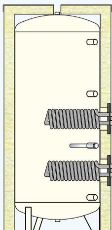
**BV2KA - Coibentazione rigida e rivestimento in PVC**
