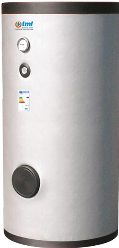
Bollitori costruiti in acciaio al carbonio vetro porcellanato per la produzione e lo stoccaggio di acqua calda sanitaria (ACS). Sono dotati di uno o due scambiatori di calore interni a serpentino fissi che possono essere alimentati da una pompa di calore e da un impianto solare o caldaia tradizionale. Lo speciale scambiatore di calore a doppia spirale parallela consente una trasmissione più efficace della potenza erogata
