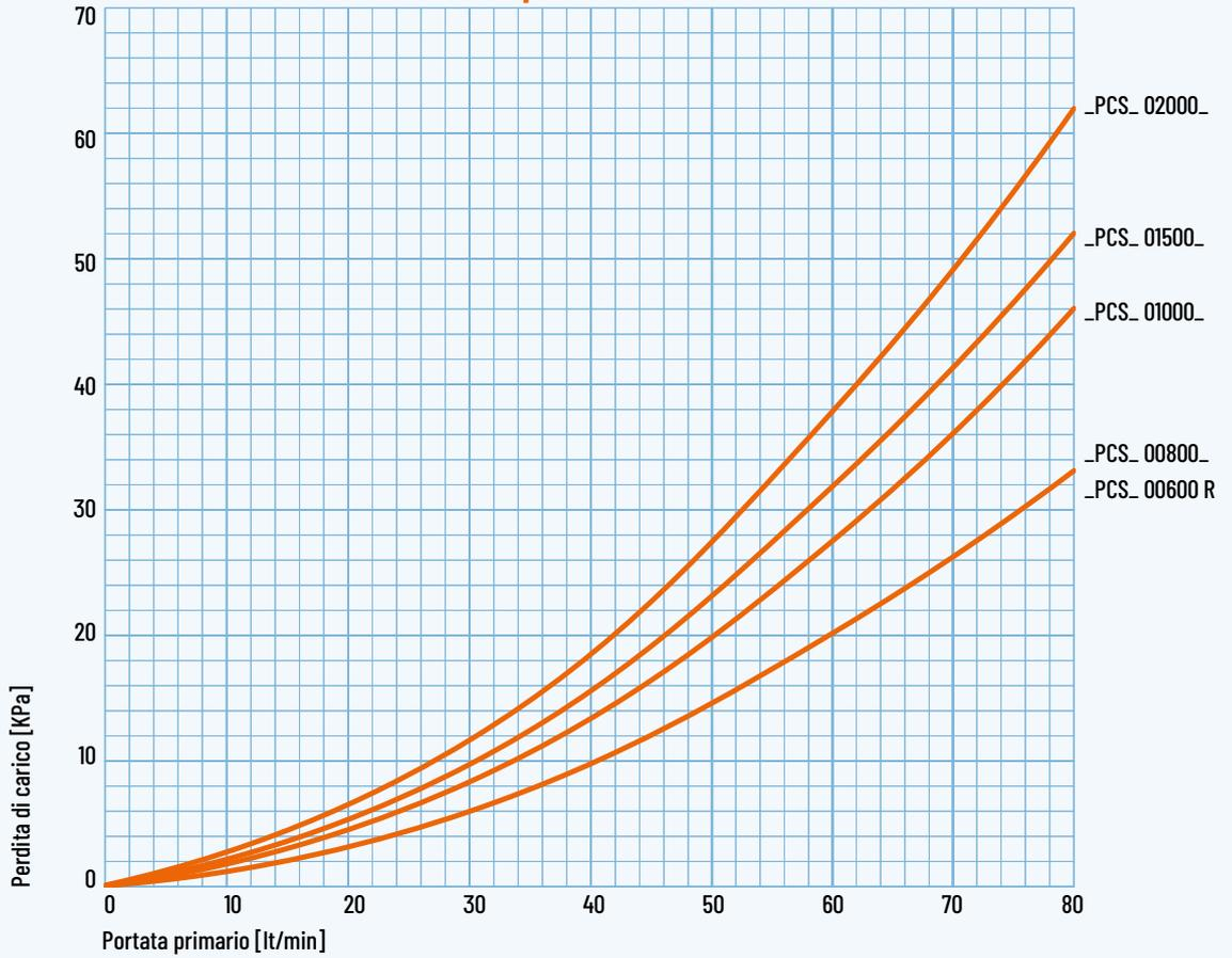
**Perdite di carico scambiatori sup. primario termoaccumulatore combinato \_PCSS**
