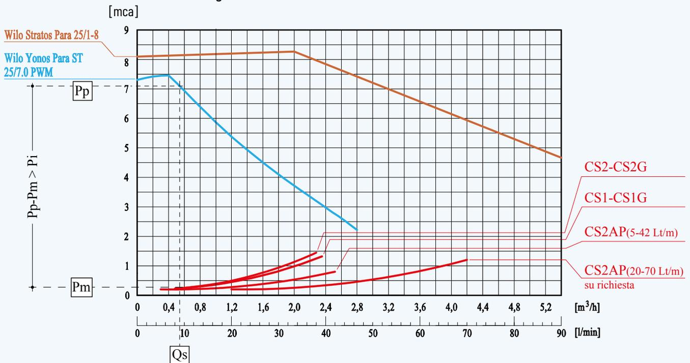
Si osserva che a seconda del Modulo Solare scelto e del valore di portata considerato ( $Q_s$ ) si definisce un intervallo più o meno ampio del valore di pressione a disposizione per superare le perdite di carico presenti sull'impianto.
