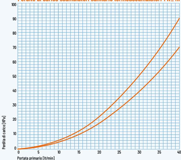
Perdite di carico scambiatori d'integrazione termoaccumulatori TWI HP
