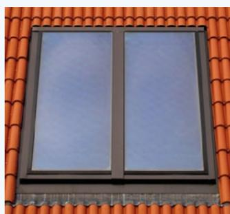
Kit per l'installazione da incasso di collettori piani PTML2.1AV (2.1mq) e PTML2.6AV (2.6mq). L'installazione da incasso su tetti a falda si avvale di kit che permettono di integrare nel tetto i collettori piani PTML2.1AV e PTML2.6AV. Il fissaggio del collettore viene eseguito direttamente sul solaio di copertura mediante l'utilizzo del telaio di supporto (Cod. SKI non incluso) attorno al quale verrà posizionata la cornice di tenuta.
