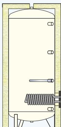
**BV1KA - Coibentazione rigida e rivestimento in PVC**
