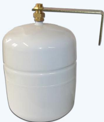
Vaso di espansione specifico per impianti solari, conforme alla Direttiva Europea 2014/68/UE sui dispositivi in pressione (PED). Equipaggiato con una speciale membrana in gomma SBR anticalcare che separa il lato aria dal lato contenente il liquido. Costruzione in acciaio con trattamento anticorrosivo del lato atto a contenere il liquido.
