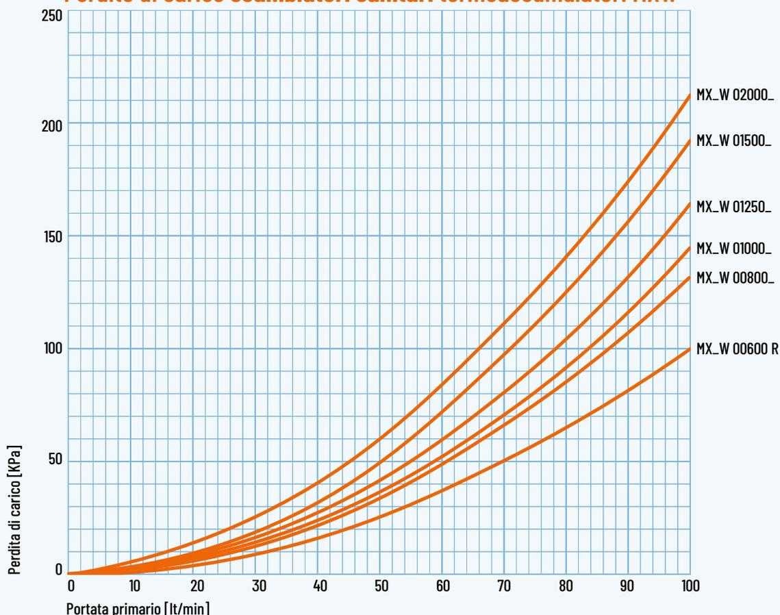
**Perdite di carico scambiatori inf. primario termoaccumulatore combinato MXW**
