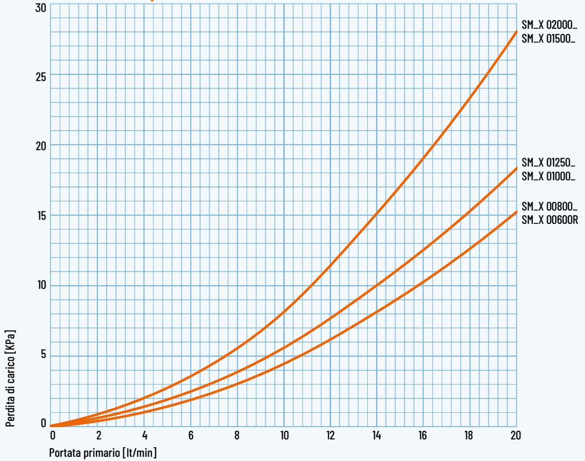
**Perdite di carico scambiatori sup. primario termoaccumulatore SMX**
