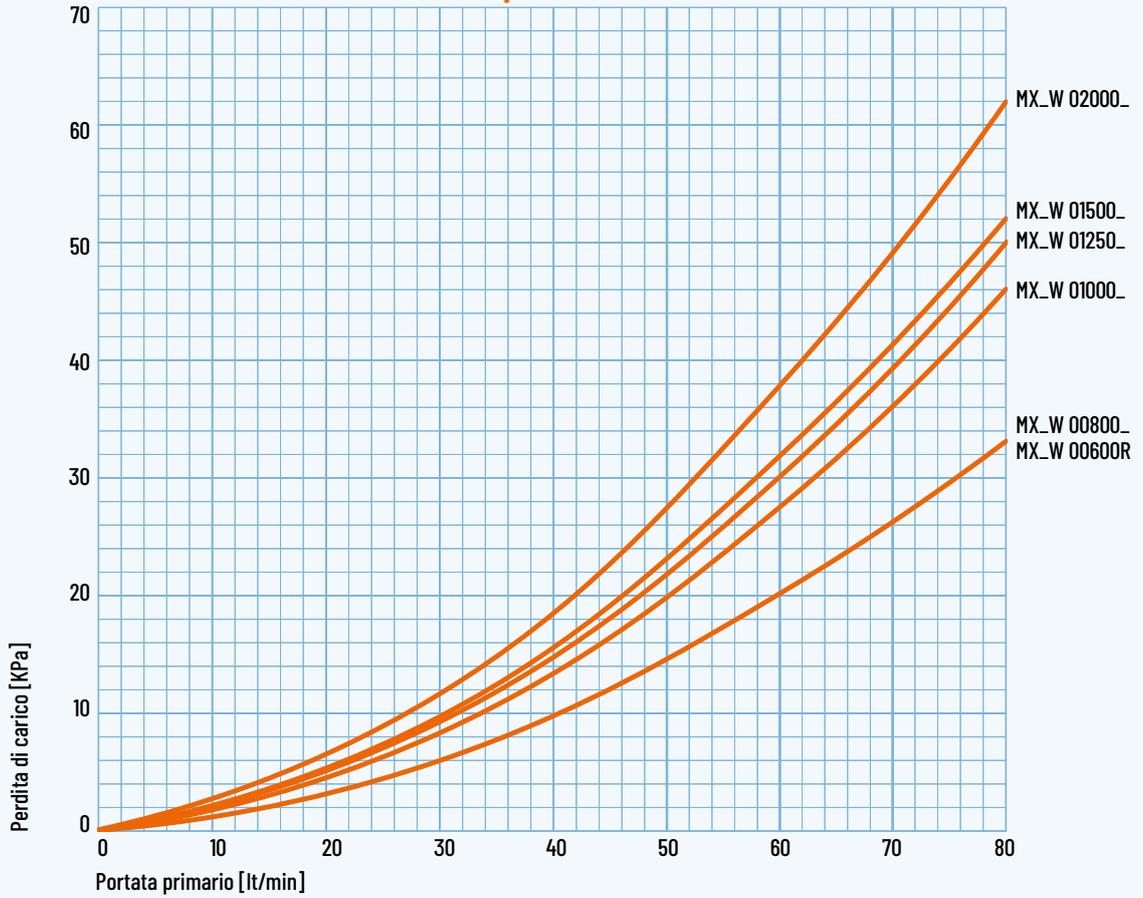
**Perdite di carico scambiatori sup. primario termoaccumulatore combinato MXW**
